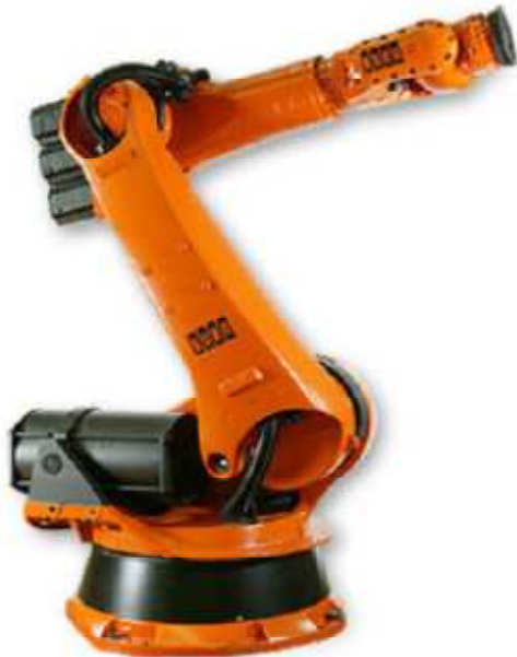
Exemple de robot à structure série KUKA, KR 240 270-2 PA (Série 2000)
