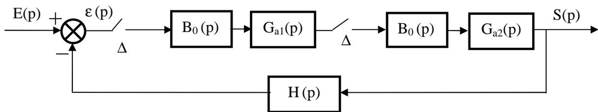
**Ex.#2** Un système en boucle ouverte échantillonné muni d'un BOZ est représenté par la figure suivante :
