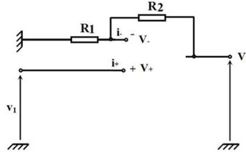
3) Il suffit d'étudier un simple circuit électrique en utilisant la loi des mailles et des nœuds ou lois de Millman.
