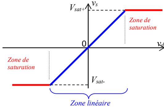
Caractéristique de transfert d'un AOP réel
