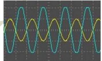
**2.1.2. Montage amplificateur non inverseur**
